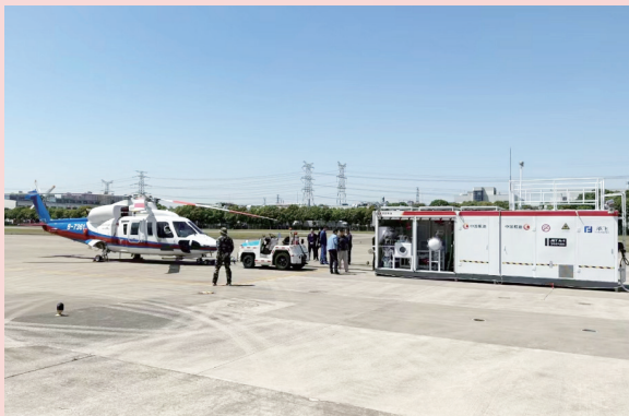
国内首台飞机自助加油站在上海高东直升机场运行
