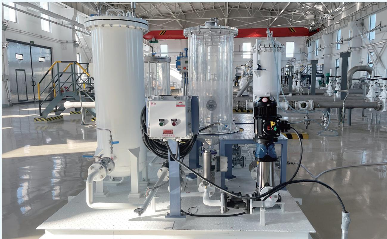
中国航油生物航油收储发工艺模拟试验装置
