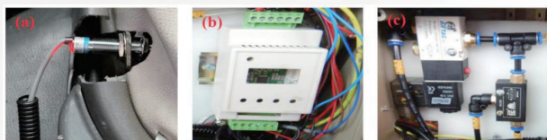
(a) 接近开关 (b) 控制器 (c) 气控阀
