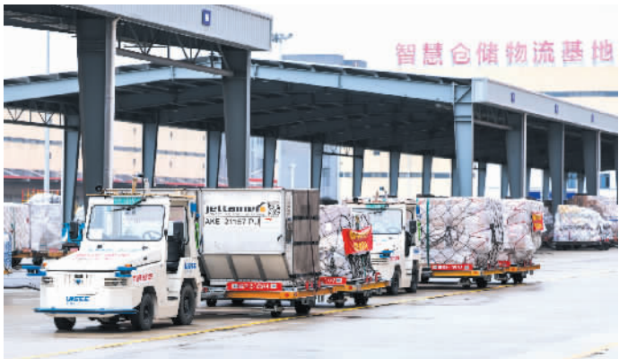
3月13日,两辆无人驾驶货物牵引车在杭州萧山国际机场投入试运行。该型无人车搭载了激光雷达、摄像头与定位系统,能够在机坪作业中实现多车协同、精准停靠装卸货等功能。 新华社记者江汉 摄
