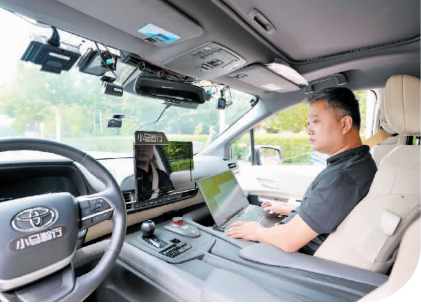
北京亦庄的自动驾驶示范区内,智能网联汽车装调运维员王伟正在一台自动驾驶测试车辆内进行车载设备的道路测试。
