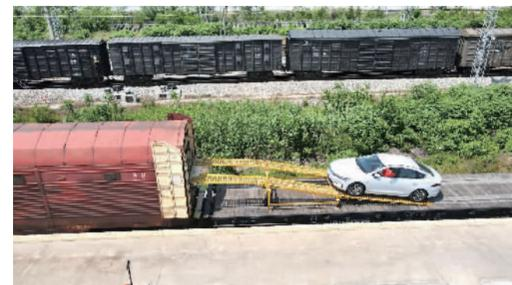
为满足比亚迪合肥基地项目新能源汽车运输需求,中国铁路上海局集团有限公司淮南西站、蚌埠货运中心积极开展新能源商品汽车铁路运输业务,通过提高水家湖货站汽车堆存量、优化运输方案等措施,保障新能源汽车铁路运输安全畅通。图为5月9日,工作人员装运新能源汽车。
