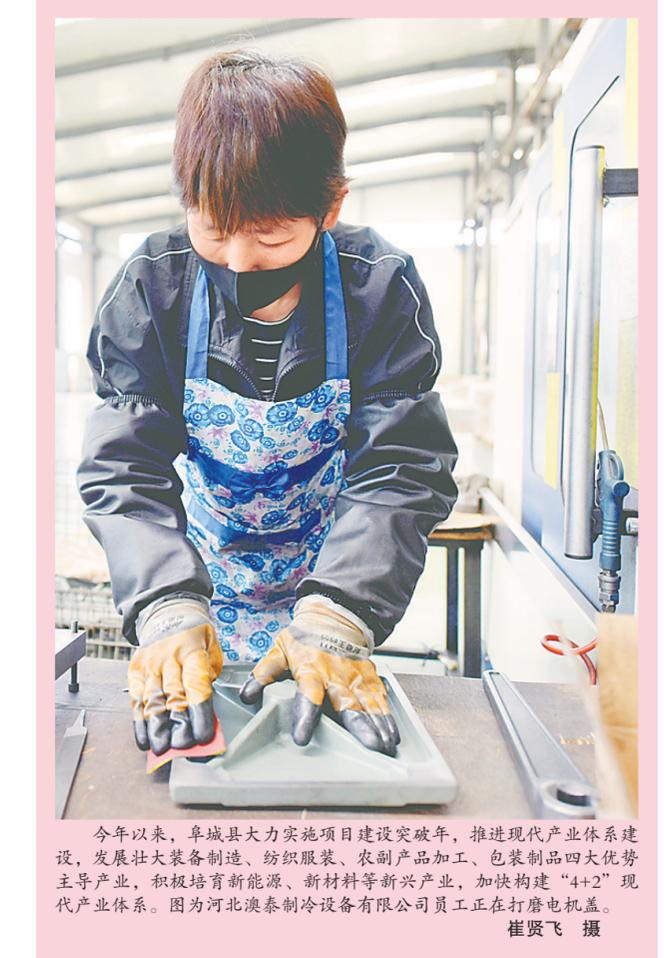
今年以来,阜城县大力实施项目建设突破年,推进现代产业体系建设,发展壮大装备制造、纺织服装、农副产品加工、包装制品四大优势主导产业,积极培育新能源、新材料等新兴产业,加快构建“4+2”现代产业体系。图为河北澳泰制冷设备有限公司员工正在打磨电机盖。崔贤飞 摄
